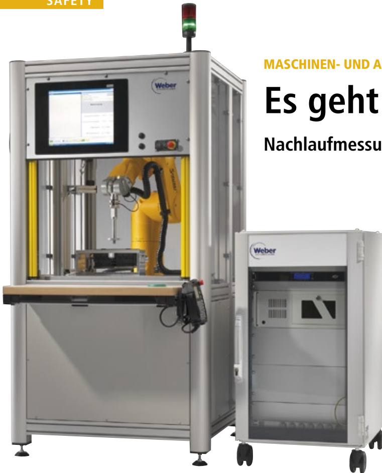
Abb. 1: Die robotergestützte Prüfeinrichtung misst die Bedienkräfte an den Lüftungsdüsen eines Pkw. (Foto: Weber Systemtechnik GmbH)
