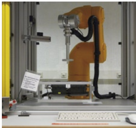
◀ Abb. 3: Das Fähnchen gibt das Signal zum Auslösen des Sicherheits-Lichtvorhangs. Dann wird die Nachlaufzeit gemessen. (Foto: K.A. Schmersal GmbH)
