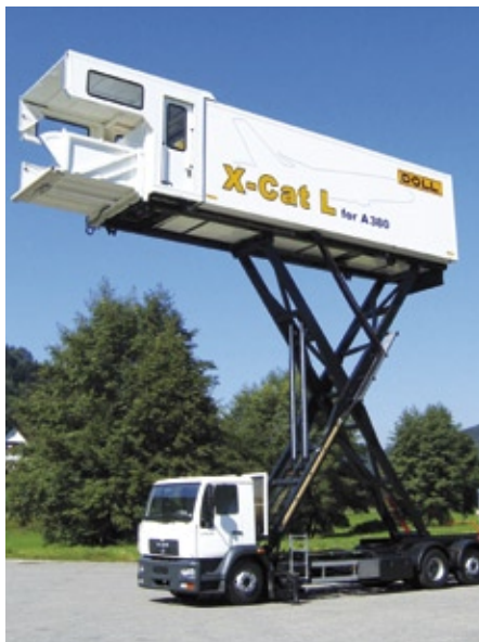
Der X-Cat für den A 380 muss auch mit ausgefahrenem Hubgerüst sicher manövrieren.
