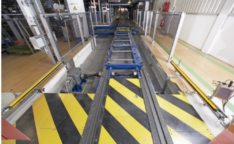
Die lernfähigen Mustererkennung ermöglicht es, an den Karosserieinlaufstellen der verschiedenen Roboterstationen sicher zwischen Betreten und Transportieren zu unterscheiden.
