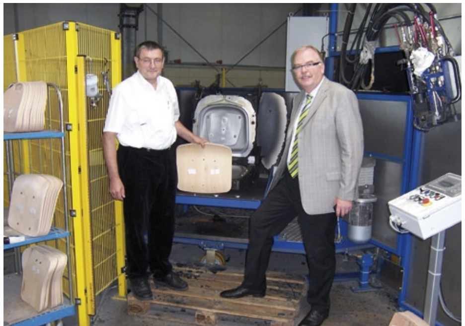
Abb. 1: Nach dem Einlegen der einzuschäumenden Sitzplatte aus Sperrholz überprüfen Elmar Winterhalter und Andreas Strangfeld die Sicherheit der Polyurethan-Verarbeitungsanlage mit 10 Rundtischstationen.
