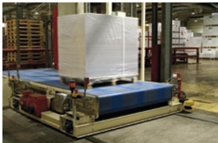
Abb. 1: Verschiebewagen sind in beide Fahrtrichtungen mit einem Sicherheits-Laserscanner ausgestattet.
