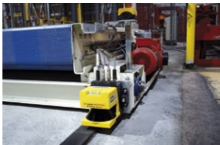
Abb. 2: Mit der Profibus-Schnittstelle lassen sich die Sicherheits-Laserscanner Rotoscan RS4-4M schnell in das Sicherheits-Netzwerk einbinden.
