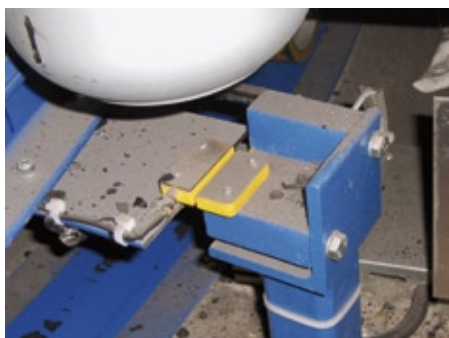
Abb. 2. Der berührungslos wirkende Sicherheitssensor
