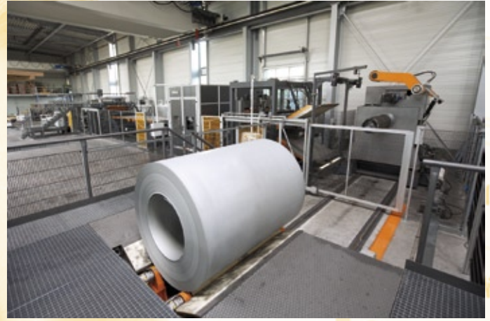
Materialzuführung an eine Haspel. In der Sicherheits-Matrix definiert Kohler für jeden Maschinenbereich einen Abschaltkreis zur Überwachung der Zugänge.
