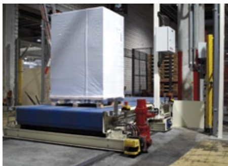
Abb. 3: Neben den Sicherheits-Laserscannern sorgen Mehrstrahl-Sicherheits-Lichtschränke von Leuze electronic mit ihrer intelligenten Muting-Funktion für permanenten Personenschutz bei ungehindertem Materialfluss.
