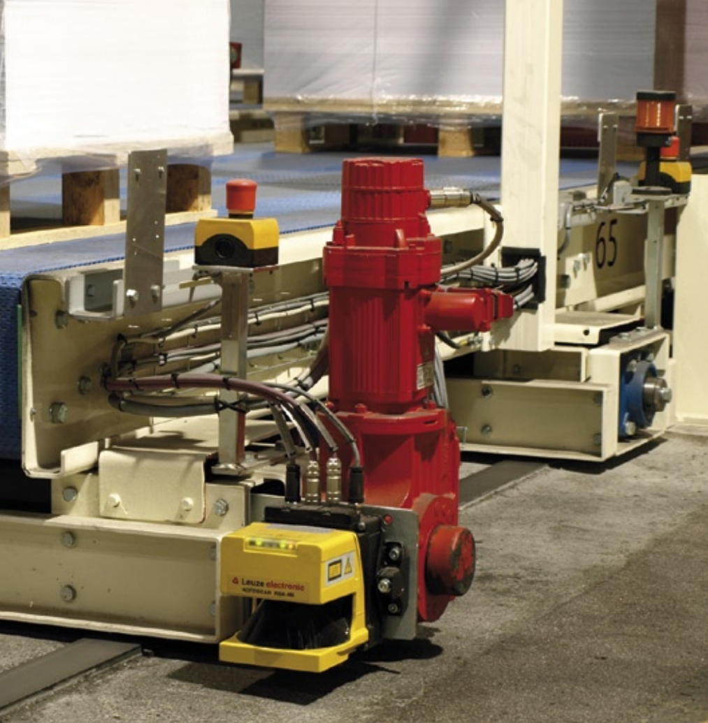
Abb. 1: Verschiebewagen sind in beide Fahrtrichtungen mit einem Sicherheits-Laserscanner ausgestattet.
