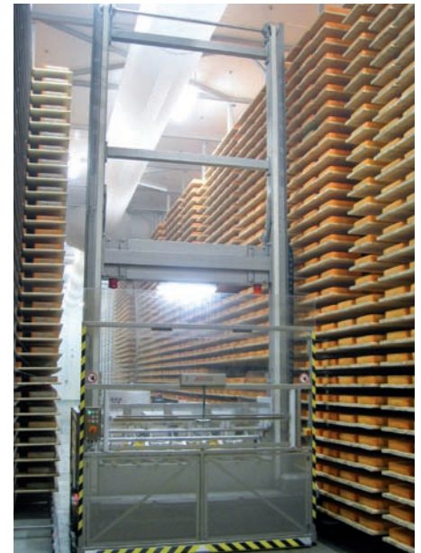
Abb. 1: Der Käsepflegeroboter LK-40 von LEU kann bis zu 800 Laibe pro Stunde pflegen. (Foto Leu Anlagenbau AG)
