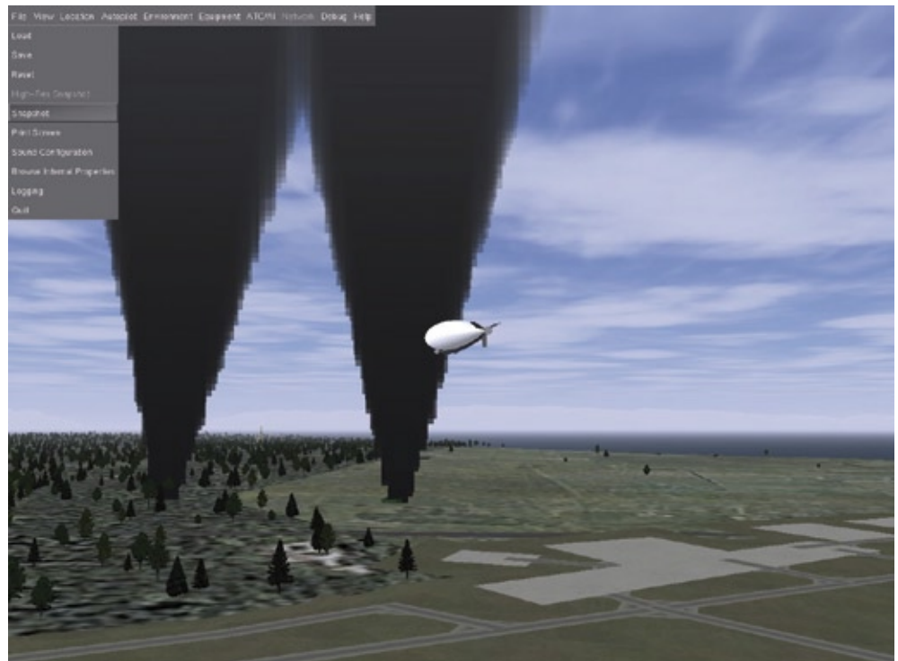
Ein Einsatzfeld des Minizep in der Simulation: Messungen innerhalb von Schadstoffwolken (Foto: ZLT)
