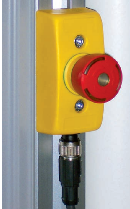
Abb. 2: Not-Halt-Taster Smile mit eingebauter Tina-Schnittstelle und mehrfarbiger LED-Anzeige. Die mittigen Befestigungslöcher erleichtern den Einbau an Aluminiumprofilen. (Foto: Jokab Safety)
