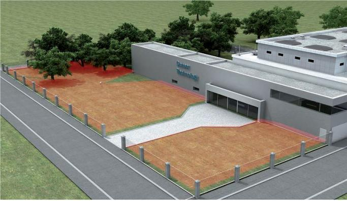
Horizontale Flächen können mit dem LMS53x ebenso überwacht werden wie vertikale Ebenen.
