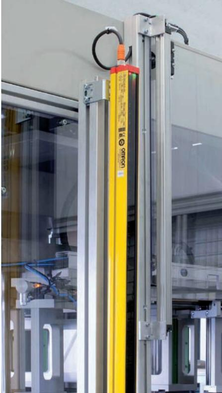
Wo sich durch konstruktive Maßnahmen Maschinen nicht komplett sicher gestalten lassen, sorgen Sicherheitssensoren dafür, dass der Anwender nicht in gefährliche Bereiche gelangen kann.
