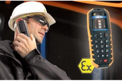
Das Mobiltelefon und Online-Tracking-System Pegasus von Bartec ist speziell für den Industrieinsatz konzipiert. Durch seine robuste Ausführung und die hohe Schutzart IP 65 eignet es sich für den Einsatz bei Umgebungstemperaturen von  $-20^{\circ}\text{C}$  bis  $60^{\circ}\text{C}$  in der
