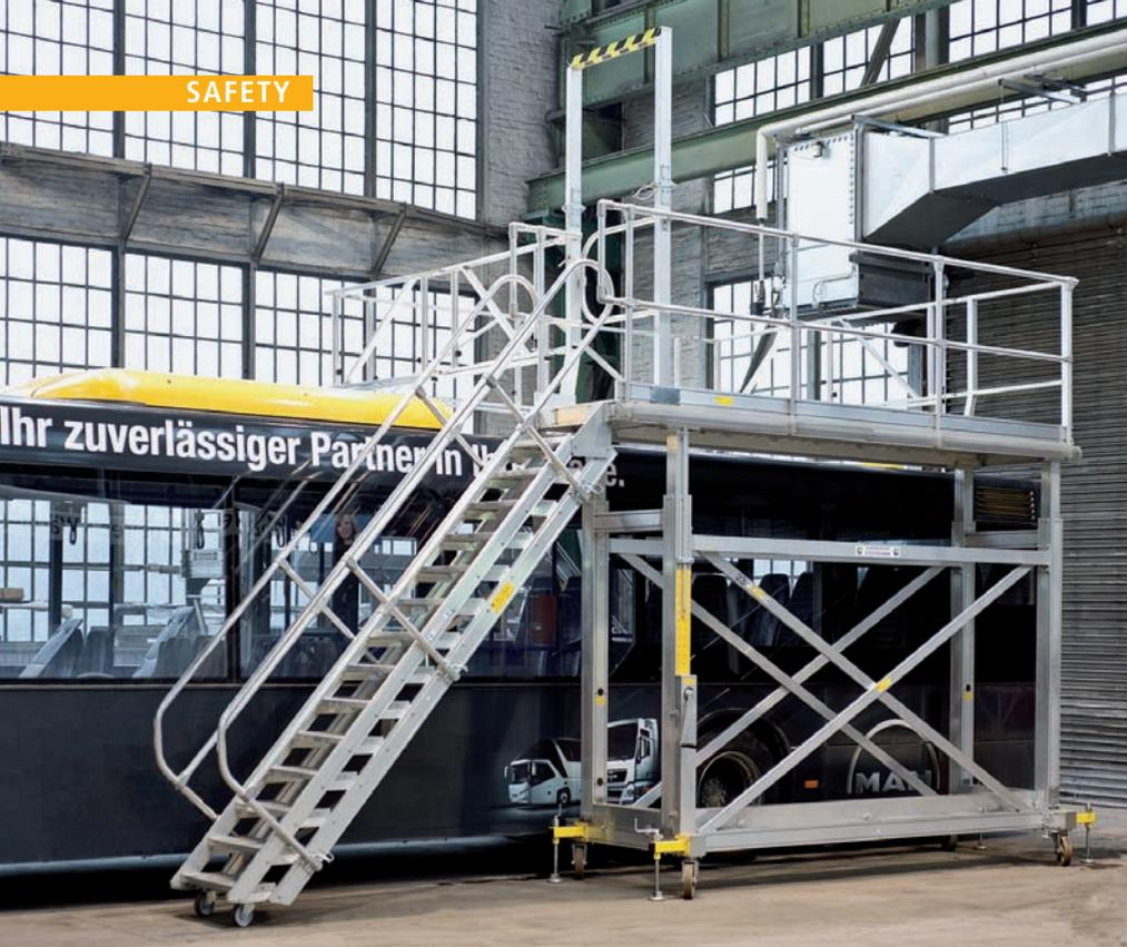
Sonderkonstruktionen der Günstzburger Steigtechnik kommen oft in der Wartung von Nutzfahrzeugen zum Einsatz. (Foto: Günstzburger Steigtechnik)
