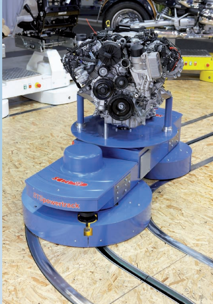
Mobile Montageplattformen gehören zu den Fahrzeugtypen, für die eine geringe Bauhöhe wie beim S300 Mini entscheidend ist.
