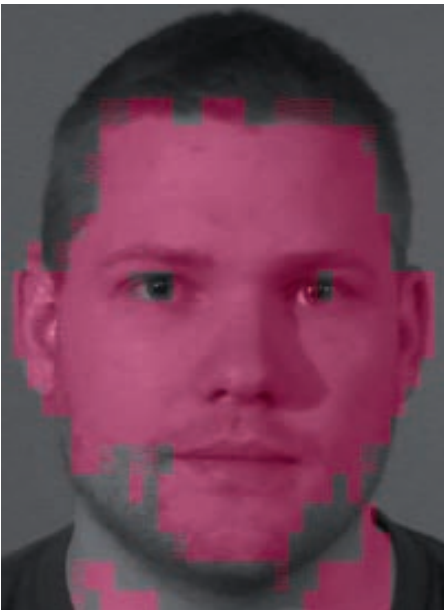
Abb. 3: Diese Illustration stellt die als ROI erkannten MBs in Pink dar. (A) Linkes Bild: ROI; (B) Rechtes Bild: ROI-Erkennung mit Morphologie-Algorithmen.
