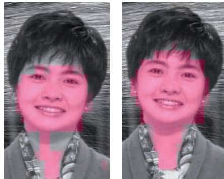
Abb. 4: Ergebnis der in den Encoder integrierten ROI-Erkennung. (B) Rechtes Bild: Ergebnis der ROI-Erkennung im Zuge der Vorverarbeitung.
