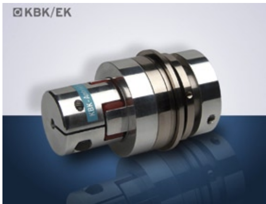
Der Elastomerstern der Serie KBK/EK kompensiert auch Stöße und Vibrationen und wirkt zudem elektrisch isolierend.
