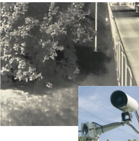
Sich im Wind bewegende Äste haben an diesem Standort viele Fehlalarme verursacht, daher entschied der Leiter des Kontrollzentrums, die Videoüberwachungskamera hier durch eine Wärmebildkamera zu ersetzen. Seitdem ist kein einziger falscher Alarm mehr aufgetreten.
