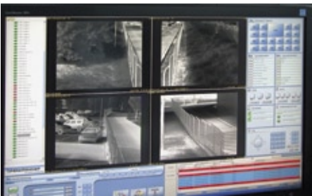
Die visuelle Analysesoftware ist deutlich effektiver, wenn das Bildmaterial von Wärmebildkameras geliefert wird. „Ein Eindringling ist durch den thermischen Kontrast klar und deutlich zu erkennen“, erläutert Thomas Krüger.
