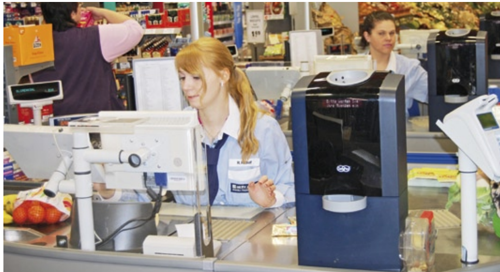
Kasse ohne Kassenschublade: Über die SafePay Münzeinheit können Kunden Münzen selbst einzahlen, die Kassiererin übernimmt die Eingabe der Geldscheine in die Banknoteneinheit. Anschließend gibt das System das passende Wechselgeld automatisch aus.
