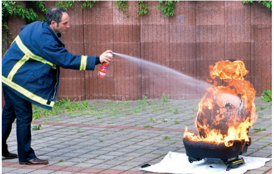
Sprühdauer von 25 Sekunden , Abstand zur Brandquelle vier Meter: Auch Experten von der Feuerwehr bescheinigen dem System die Tauglichkeit
