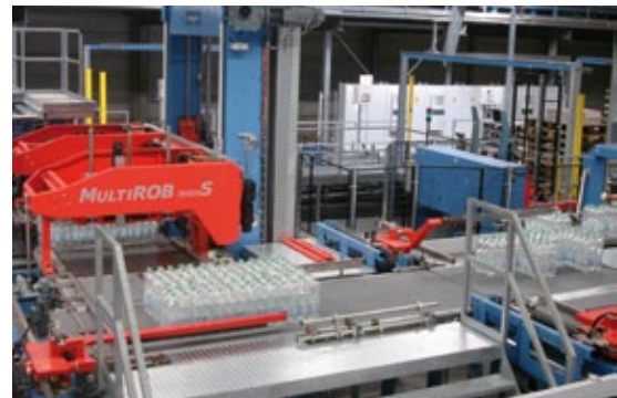
▲ Schaefer Anlage mit Lichtschranken-Sets.
