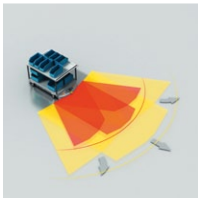
▲ Beim „Speed Routing“ sammelt ein Encoder Geschwindigkeitsinformationen, die über die EFI-Schnittstelle den Sicherheits-Laserscannern S3000 bzw. S300 zur Verfügung gestellt werden.
