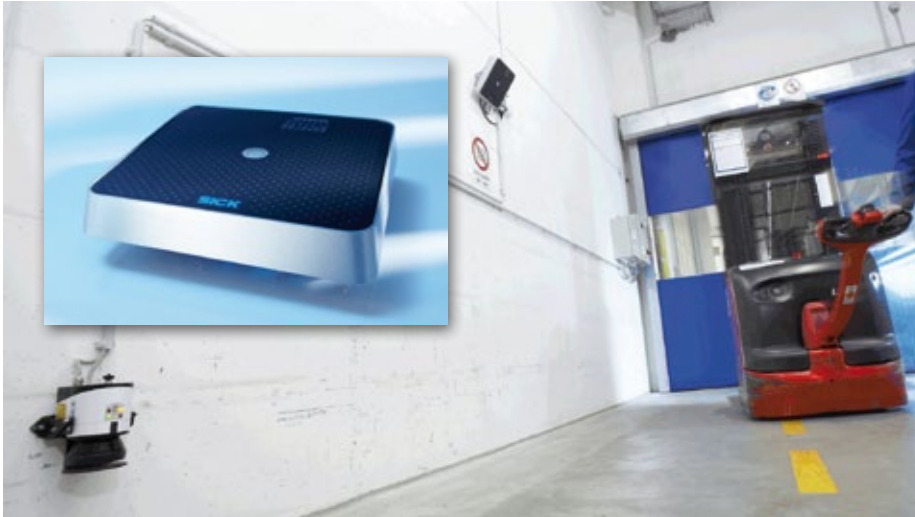
Sensortechnisch kommen im LAC der Lasermesssensor LMS123 (im Bild links unten) sowie das UHF-Identifikationssystem Interrogator RFU630 (im Bild eingeklinkt und mittig oben) zum Einsatz.
