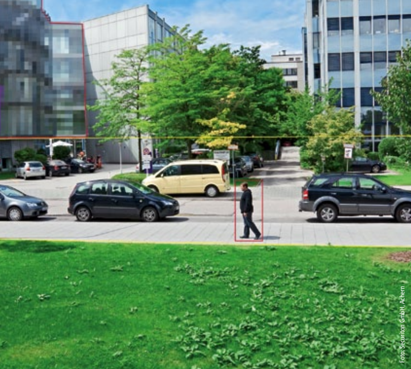
Das Modul „IPS Privacy Protection“ kann bestimmte Bereiche mit frei wählbarer Geometrie verschleiern.
