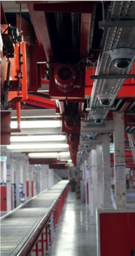
▲ Videodokumentationssystem an einer Transportbandstrecke im DPD-Depot Heilbronn
