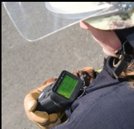
▲ War 2009 Gewinner beim GIT SICHERHEIT AWARD und ist Standardausrüstung für viele Überwachungsaufgaben: 7-Gas-Messgerät Microtector G460 – hier im Einsatz bei der Feuerwehr
