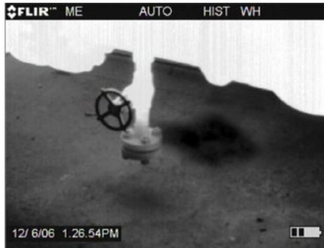
Auf dem bewegten Bild als schwarze Wolke noch deutlicher zu Erkennen: eine im normalen Spektrum unsichtbare Gasverbindung
