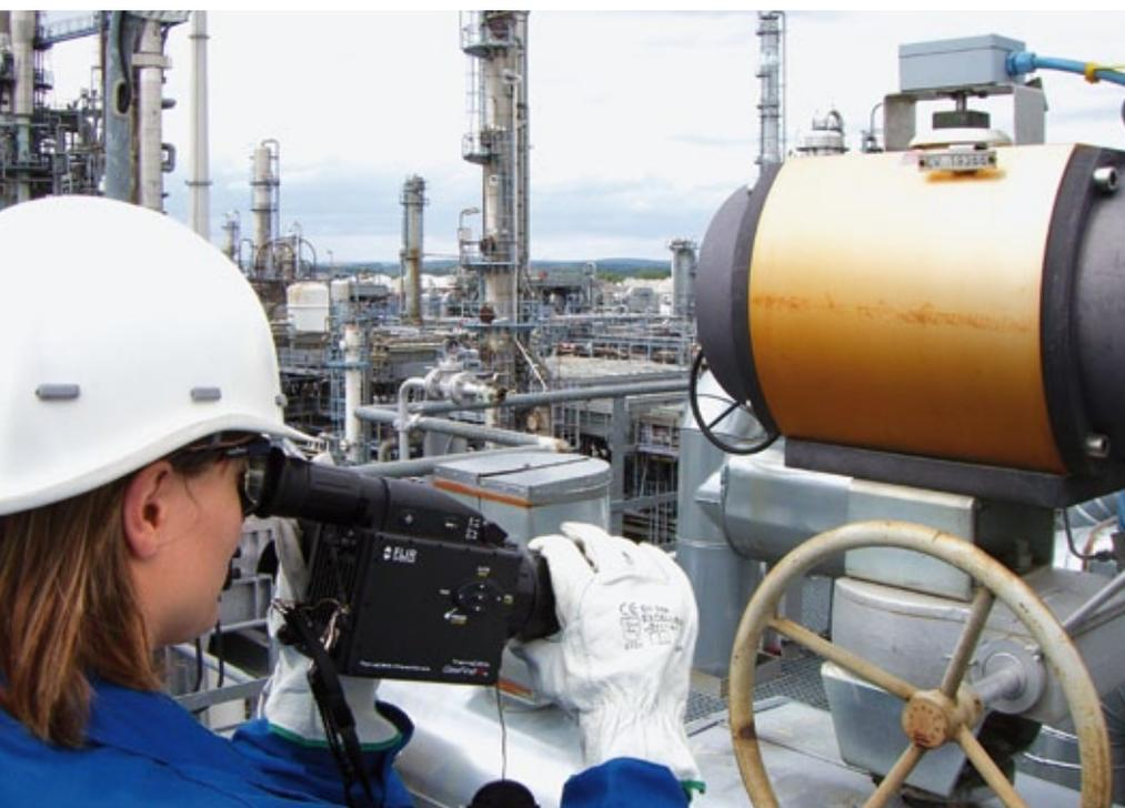
◀ Untersuchung von Chemieanlagen mit der GF-Serie
