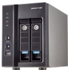
aktuelle Topmodell der Digiever 8200er-Serie, Digistor DS-8225-RM Pro, ermöglicht Full-HD Monitoring in 1.080 p mit bis zu 200 Bildern pro Sekunde und bietet VGA- und HDMI-Anschlussmöglichkeiten. [www.efb-elektronik.de](http://www.efb-elektronik.de)
