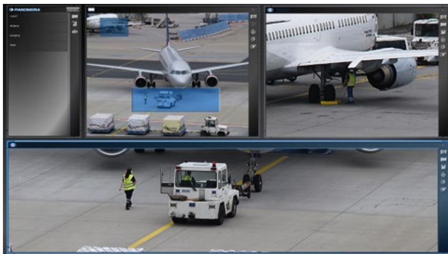
Das Seitenverhältnis kann bei Multifocal-Sensorsystemen der jeweiligen Situation angepasst werden und ist nicht an feste Formate wie 16:9 oder 4:3 gebunden
