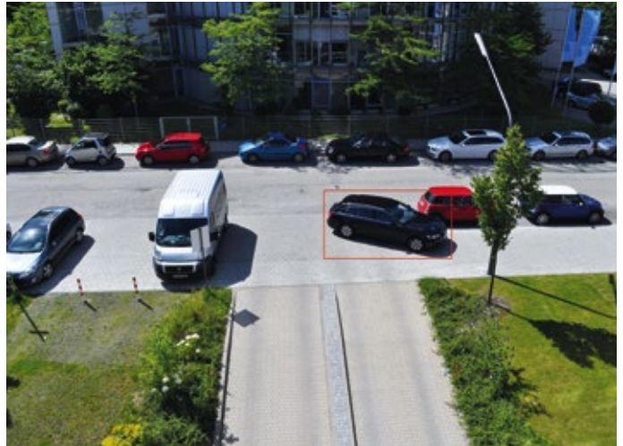
„IPS Parking Violation Detection“ – intelligentes Videoanalyse-Modul für die Echtzeit-Alarmierung bei unerlaubtem Anhalten von Fahrzeugen in überwachten Bereichen
