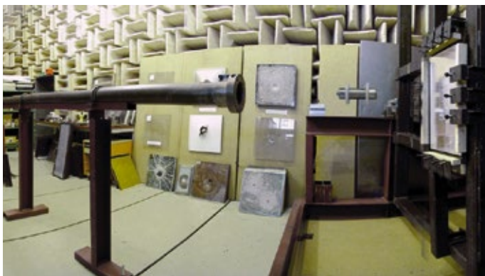
Alle von HEMA verwendeten Scheiben und Komponenten werden im Beschussinstitut IWF Berlin nach „EN 23125 Beschussklassen A1 bis C3“ auf ihr Rückhaltevermögen getestet
