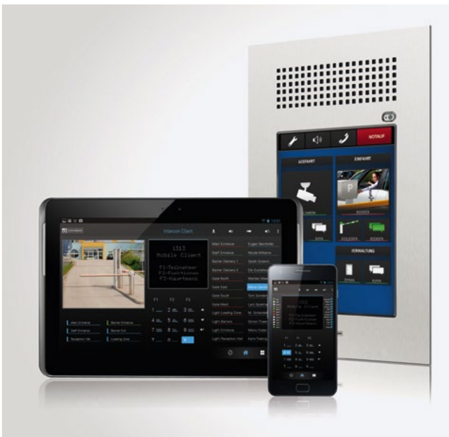
Harmonischer Dreiklang im Intercom-System: Sprechstelle, Smartphone und Tablet.
