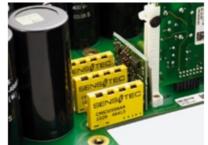
CMS3000 Stromsensoren von Sensitec: hochdynamisch und präzise
