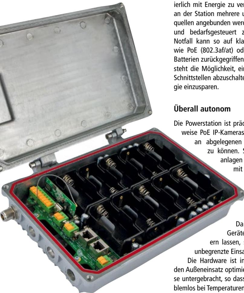
Die Powerstation von Allnet enthält ein integriertes Ralink W-LAN Modul, das die Wireless Kommunikation sicherstellt. Mit einem 3G- oder LTE Router lassen sich die gewonnenen Daten direkt in das Unternehmensnetzwerk einspeisen. So können auch eventuelle Wartungs- oder Konfigurationsarbeiten Remote ausgeführt werden, was die Flexibilität erhöht und gleichzeitig die Kosten reduziert.
