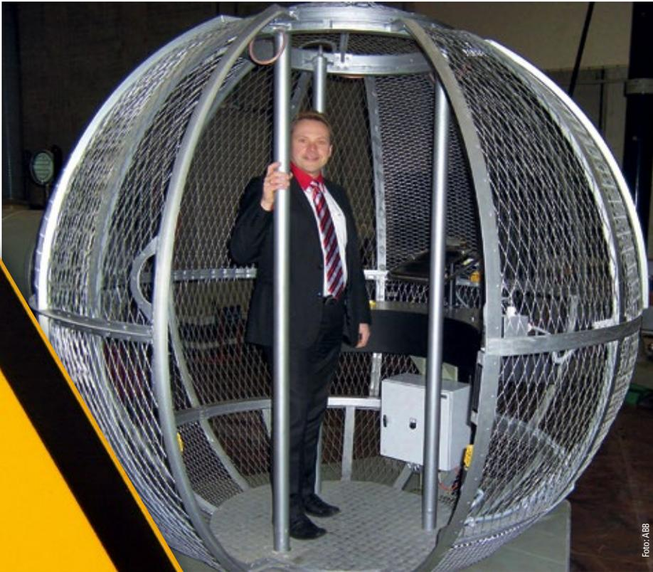
◀ Günther Bissle, Key Account Manager bei ABB Stotz-Kontakt GmbH, begutachtet die mit Sicherheitssensoren, Not-Aus-Taster und magnetischer Zuhaltung ausgerüstete Faraday-Kugel
