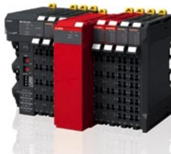
Der Sysmac Safety-Controller erfüllt die höchsten Sicherheitsanforderungen bis PLe und Kategorie 4 gemäß DIN EN ISO 13849-1 sowie SIL3 gemäß IEC 61508
