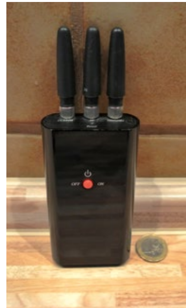
▲ So klein ist ein „Jammer“. Das leicht erhältliche Gerät kann den Empfang von Funkübertragungen verhindern
