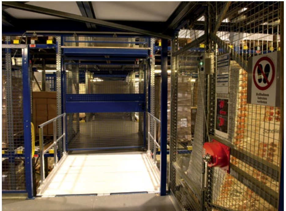
◀ Abb. 2: Die in Säulenform aufgebauten N.TEC-PRO-Module beinhalten Einstrahl-Sicherheits- v mit Infrarot- bzw. Rotlicht sowie polarisierte Reflexions- Lichtschraken und Sicherheitszuhaltungen von Leuze electronic.
