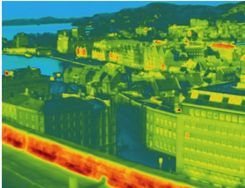
Bergens berühmtes Hanseviertel Bryggen mit rund 280 in typischer Holzbauweise errichteten Wohn- und Lagerhäusern wird permanent und vollautomatisch mit einer leistungsfähigen Infrarotkamera Dias Pyroview 380L überwacht
