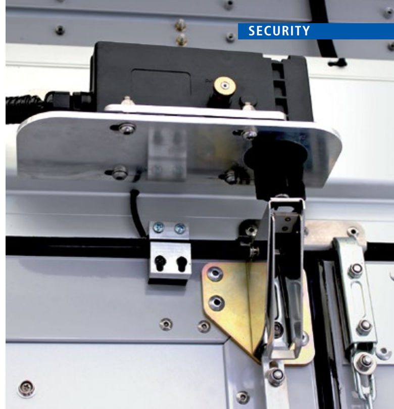
▲ Das Fahrzeugverriegelungssystem ist modular aufgebaut und bietet Systemkomponenten zur Auswahl – z.B. drei verschiedene RFID-Transponderbauformen
