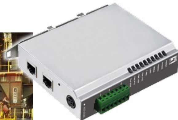
Der IED-200 ist ein Ethernet-Seriell-Konverter für den industriellen Gebrauch in rauen Umgebungen
