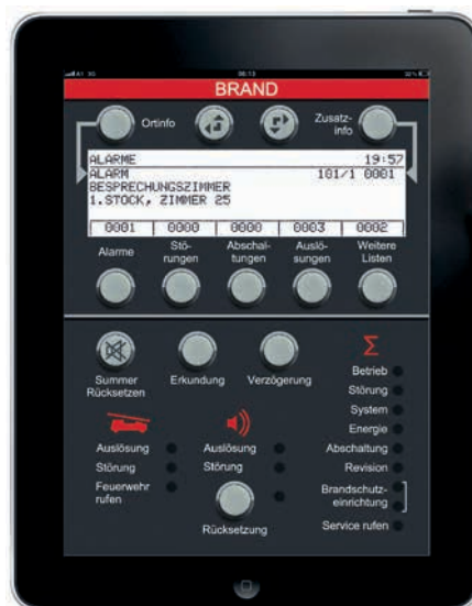
Mit Integral Remote Mobile kann unter anderem mittels iPhone und iPad auf die Brandmelderzentrale zugegriffen werden. Neu sind die Versionen für Android und Windows Phone 8
