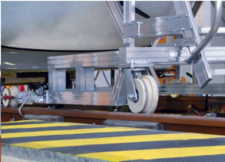
Das Gleisfahrwerk ist in Spurweite 1435 mit gebremsten Spurkranzrollen ausgestattet
