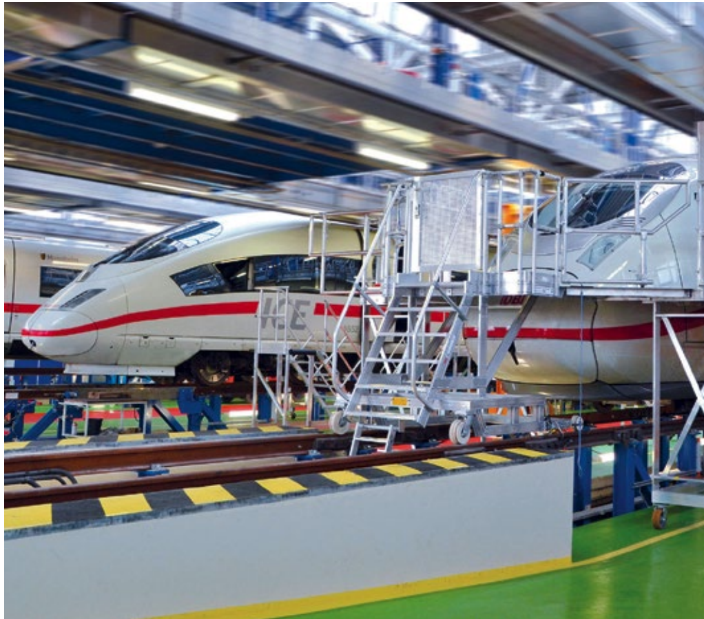
Die neueste Generation der ICE-Züge wird in Frankfurt-Griesheim mit modularen Arbeitsbühnen der Günzburger Steigtechnik gewartet
