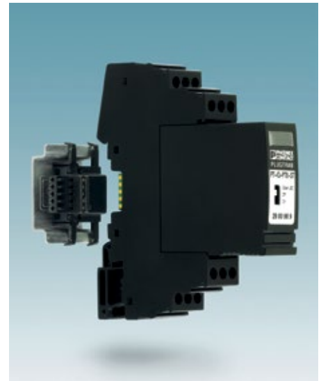
Durch das Aufrasten von Schutzgerät und Controller auf die Hutschiene wird über den Steckverbinder die Überwachungsfunktion automatisch aktiv – Verdrahtungsfehler sind dann ausgeschlossen
