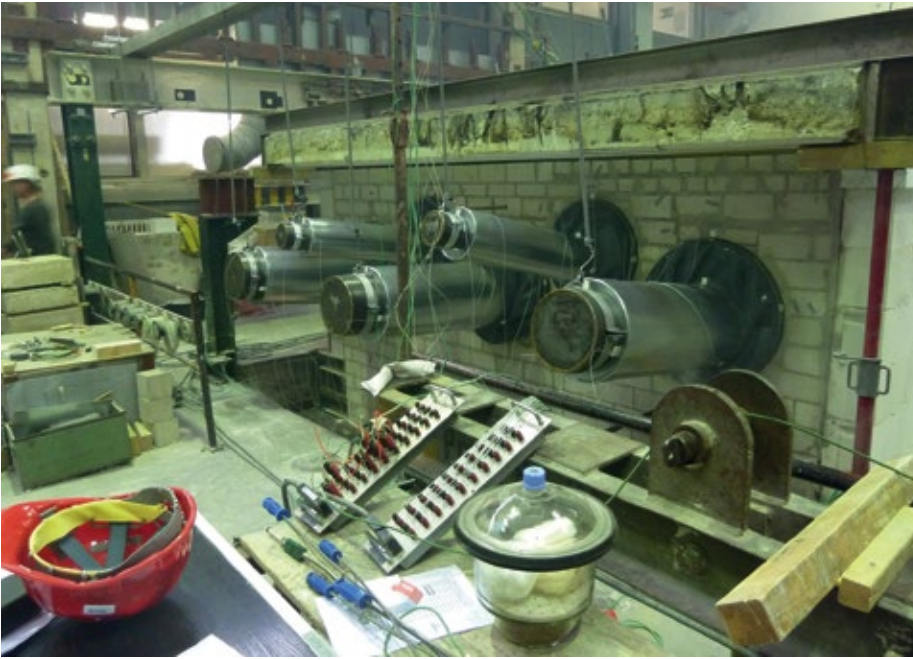
Während des Brandversuchs vom 11.04.2012: Ansicht der Lageveränderung der Rohre auf der Luftseite
