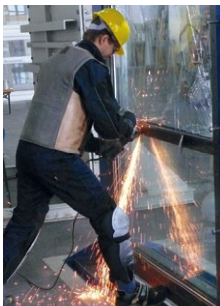
Einbruchprüfung einer Fassade in der Widerstandsklasse RC 5
