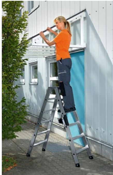
Dank eingestreuter Korunde ist der – auch als Nachrüstatz erhältliche – Kunststoffbelag der „Clip-step R13“-Leitern besonders rutschhemmend und nach R13 zertifiziert
