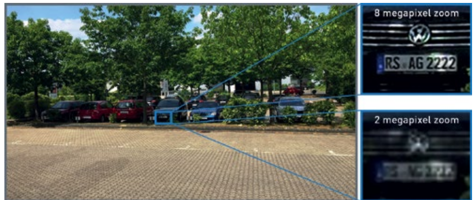
Beispiel: Full HD und 4K IP-Kamera mit 4Mbits/Sek Streaming
