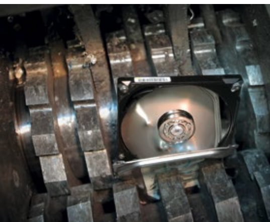
Der HSM-Festplattenvernichter erfüllt die strengen Sicherheitsanforderungen des Bundesdatenschutzgesetzes
