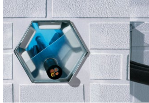
Die Kabelboxen aus feuerverzinktem Stahlblech sind im Inneren mit dämmschichtbildendem Material ausgekleidet, das sich bei einer Temperatur von 70 °C ausdehnt
