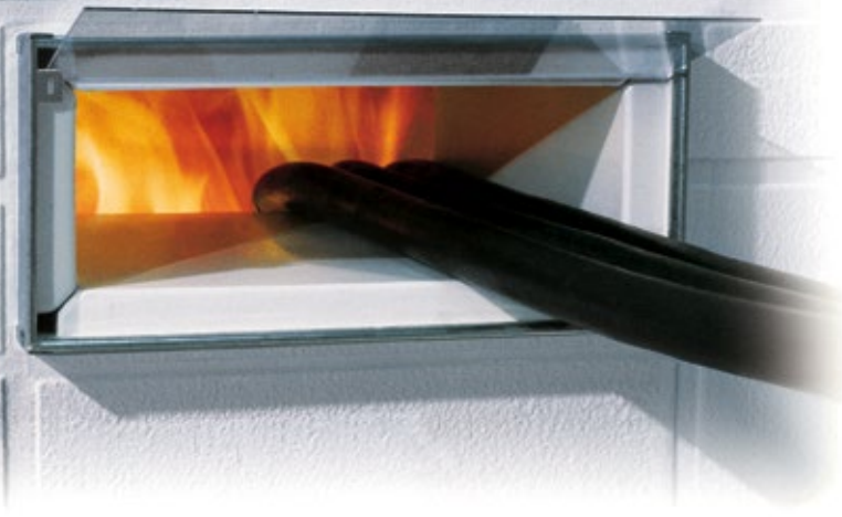
Die Kabelboxen aus feuerverzinktem Stahlblech sind im Inneren mit dämmschichtbildendem Material ausgekleidet, das sich bei einer Temperatur von 70 °C ausdehnt
