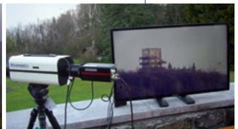
Links: fotografiert mit einer normalen Digitalkamera – rechts das Bild auf dem Monitor, wie es die Kowa-Kamera mit dem Long Range Zoom heranzoomt“
