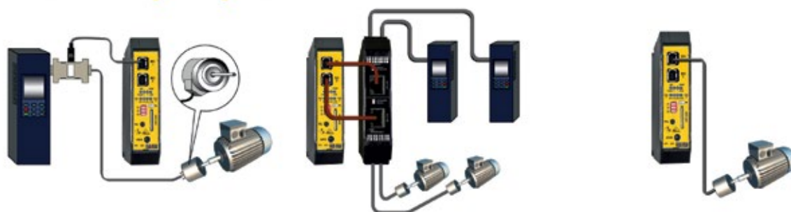
Drehgebersignal wird zwischen Drehgeber und Umrichter abgegriffen
