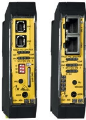
Drehzahlwächter von Bihl+Wiedemann für Sinus/Cosinus-, HTL-, SSI- und TTL-Drehgeber
