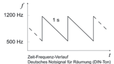
Zeit-Frequenz-Verlauf „Deutsches Notsignal für Räumung“ (DIN-Ton)
