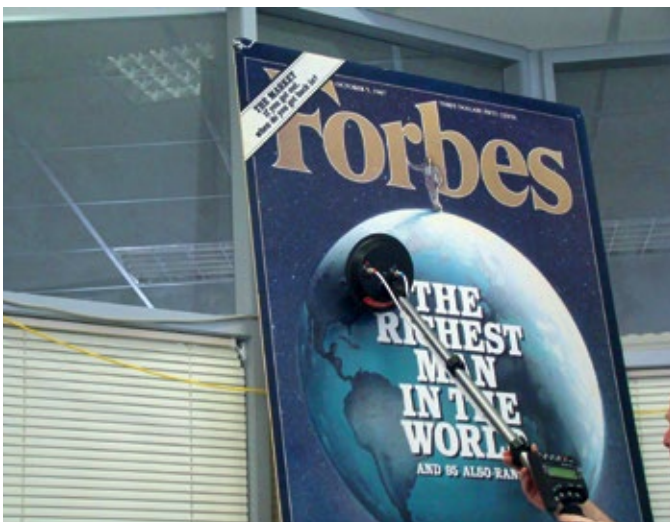
DRB-Abhörschutzteam, „Non-linear Junction Detector“, Suche nach Halbleitern Wanze in Spielball getarnt
