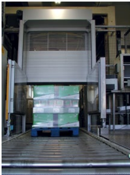
Das Sicherheits-Rolltor und die Lichtvorhänge von ReeR sorgen für sicheren Zugangsschutz und Bereichsüberwachung ▶
