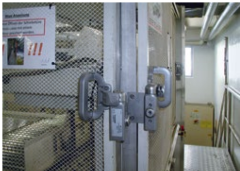
▲ Die rein mechanische Schlüsseltransfer-Zuhaltung „tGard“
