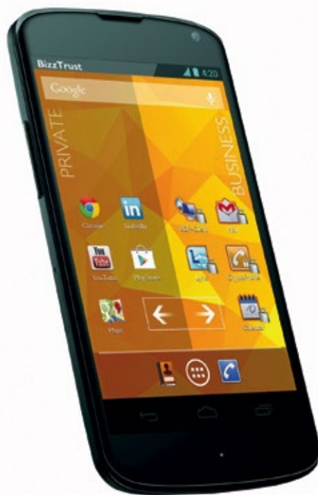
Bizz Trust ist eine sichere Android-Plattform für Smartphones und Tablets, die Geräte in zwei Sicherheitszonen unterteilt
