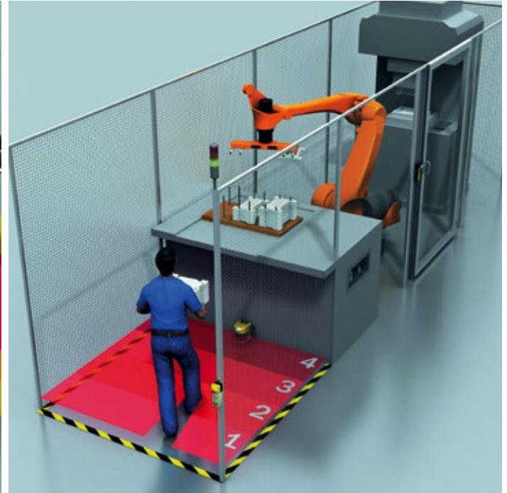
▲ Eine Interaktion, bei der sich Mensch und Maschine einen gemeinsamen Arbeitsraum teilen, aber zu unterschiedlichen Zeitpunkten darin arbeiten, erfüllt die Bedingungen einer Kooperation. Eine solche Arbeitssituation ist beispielsweise in einer Übergabestation für einen Montageroboter gegeben.
