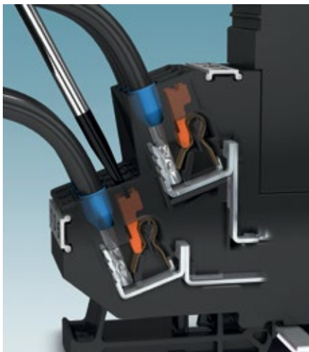
Mit der Push-in-Technik werden Leiter schnell und einfach angeschlossen – auch gelöst wird bequem und ohne Spezialwerkzeug
