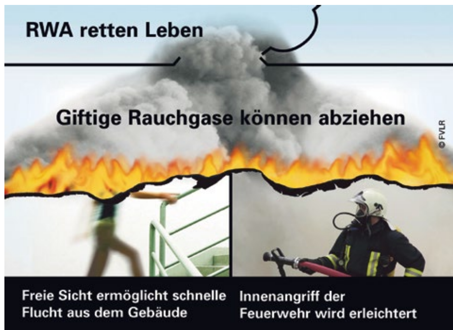
Rauch- und Wärmeabzugsanlagen erleichtern insbesondere in öffentlichen Gebäuden eine schnelle Selbst- und Fremdrettung. Quelle: Fachverband Tageslicht und Rauchschutz
