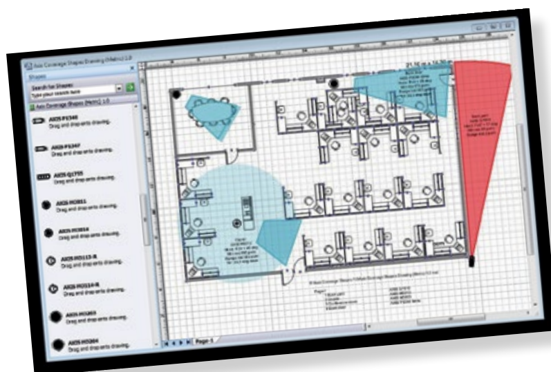
▲ Durch die direkte Integration der Netzwerk-Kameras in die Gebäude- und Raumpläne können Planer die Erfassungsbereiche, die die Kameras abdecken werden, grafisch darstellen
