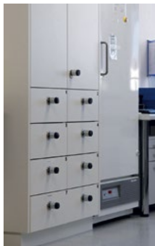
Elektronische XS4 GEO Zylinder an einem Dokumentenschrank im Kantonsspital Baden
