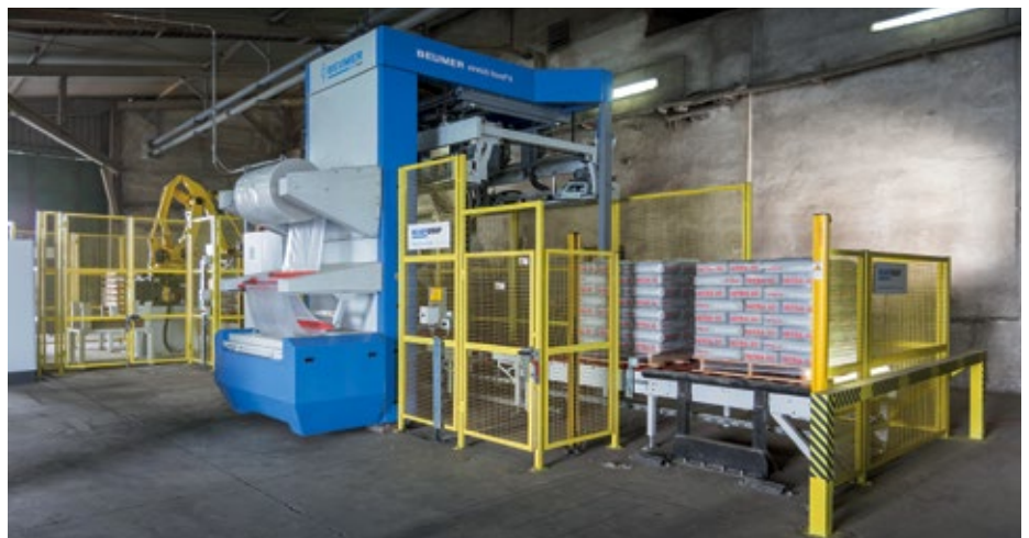
In den komplexen Palettieranlagen von Beumer kommen MLDSET Systeme in unterschiedlichen Ausführungen sowohl mit als auch ohne Muting-Sensoren zum Einsatz
