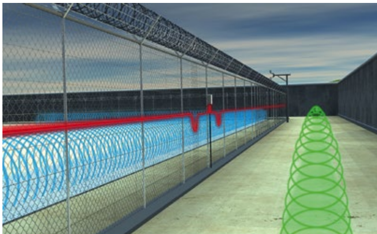
Das Bodendetektionssystem OmniTrax (blau) hinter der mechanischen Zaunbarriere mit FlexZone-Zaunsystem (rot) und einem Mikrowellensystem (grün) als erste Detektionslinie im Zusammenspiel
