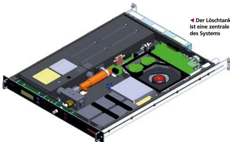
◀ Der Löschtank (links im Bild) ist eine zentrale Komponente des Systems
