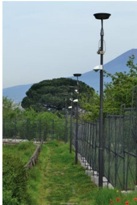
▲ Mobotix-Kameras vom Typ D25 und D15 überwachen das Gelände
