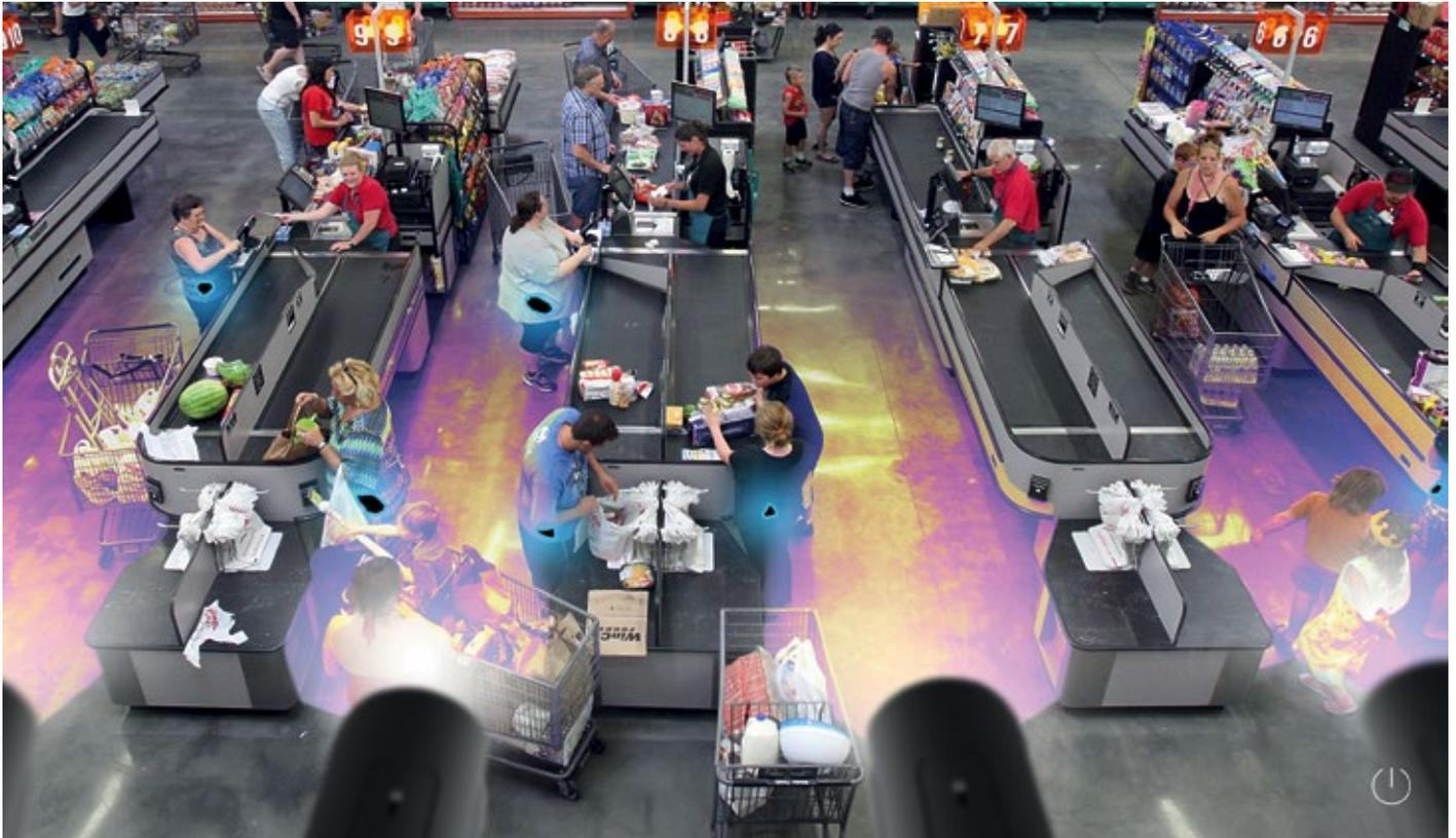
Wenn es nach der Nexo Group geht, müssen Ladendiebe vor einer neuen, besonders effektiven Diebstahlerkennungstechnik zittern: Wärmebildgebung. Basierend auf den Wärmebildern, die von den radiometrischen Flir-Kameras der FC-Serie R erzeugt werden, erkennt das xPredator-System der Nexo Group verdächtige Wärmemuster bei Ladenbesuchern, die auf mit Diebstahlsabsicht versteckte Artikel hinweisen könnten.
