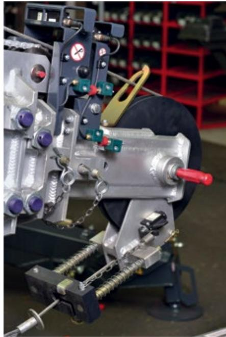
**Funk-Magnetschalter erfassen den Ausschubzustand der einzelnen Teleskope**
