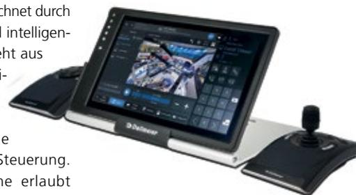
Links- wie für Rechtshänder bestens geeignet. Die Komponenten können unabhängig voneinander auch als Stand-alone-Geräte genutzt werden. Das VMC-2 ist kompatibel mit SeM-Sy-III-Videomanagementsystemen und geprüft nach DIN EN 50130-4.
