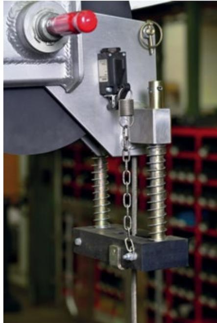
Ein Funk-Seilzugschalter veranlasst den Stopp der Winde, wenn die Kranflasche die obere Endposition erreicht
