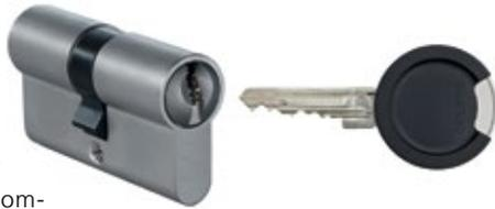
Identifikationsmedium, auch an elektronischen Schlössern, Zylindern oder Wandlesern. Die mLock-multi-Zylinder verfügen über sechs gefederte Stiftzuhaltungen und bieten hohe Sicherheit. Geprüft nach DIN EN 1303: 2005 entsprechen sie der Verschlussicherheitsklasse 6 sowie der Angriffswiderstandsklasse 2.
