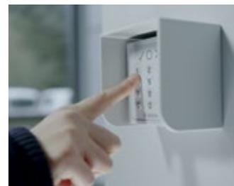
entsprechenden Berechtigungen für Zutritte und das Scharf- und Unscharfschalten der Einbruchmeldeanlage von Bosch werden im Matrix-Controller hinterlegt.
