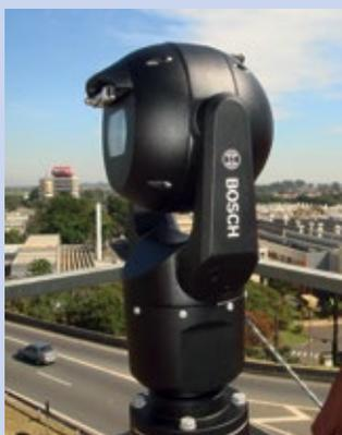
wendet. Ebenfalls integriert ist ein Gebläse, das von innen warme Luft auf die Innenseite der Frontscheibe bläst, um sie bei Bedarf zu enteisen. Wenn die Kamera über ihre Videoanalysefunktion Nebel entdeckt, wird das Videobild automatisch aufgehellt. Firmware-Updates können aus der Ferne aufgespielt werden. Das nahezu unzerstörbare Gehäuse und die Selbstreinigungsfähigkeit machen Service-Einsätze vor Ort nahezu überflüssig.
