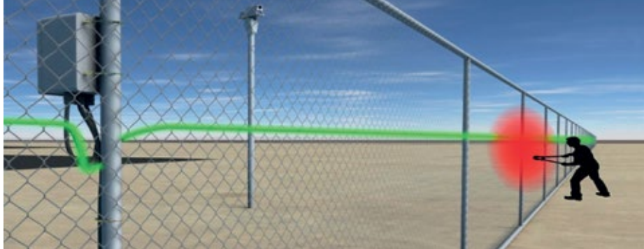
Elektronische „Fühler“: Überklettern, Durchtrennen oder sonstige Sabotage am Zaun wird zuverlässig detektiert und an eine übergeordnete Alarmmanagementanlage gemeldet
