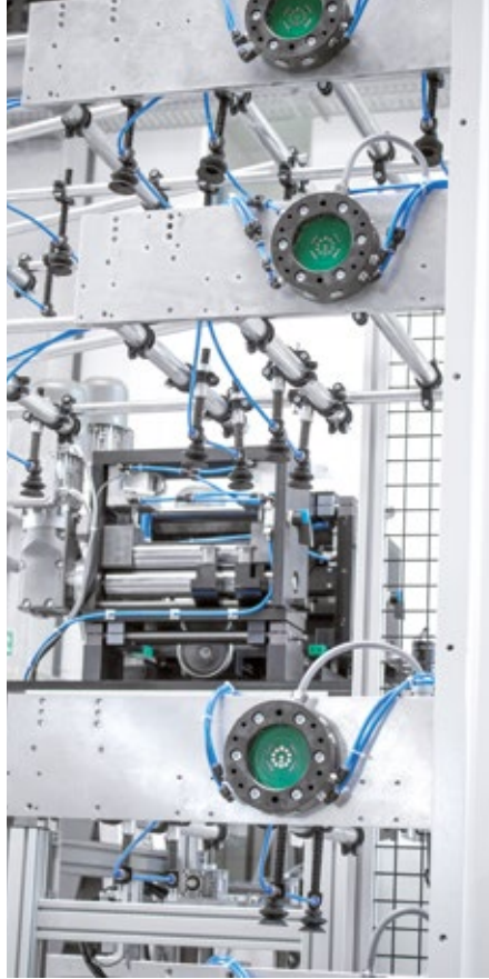
▲ Die Werkzeugplatten von RSP können dank dem patentierten Verschlussystem „True Connect“ mit höchster Präzision aufgenommen werden
