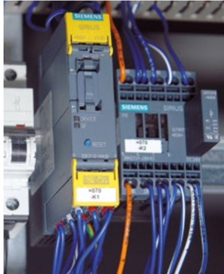
Das Sicherheitsschaltgeräte Sirius 3SK2 von Siemens ist nur 22,5 mm breit und wird über Software parametrierbar. Mit zehn einkanalen Eingängen und zwei Ausgängen eignet es sich ideal für einfache Sicherheitslösungen
