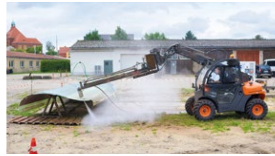
Matetec aus Sachsen-Anhalt entwickelte eine maschinengeführte Schneidvorrichtung zum Wasserstrahlschneiden, die bei der Zerkleinerung von Rotorblättern von Windenergieanlagen zum Einsatz kommt
