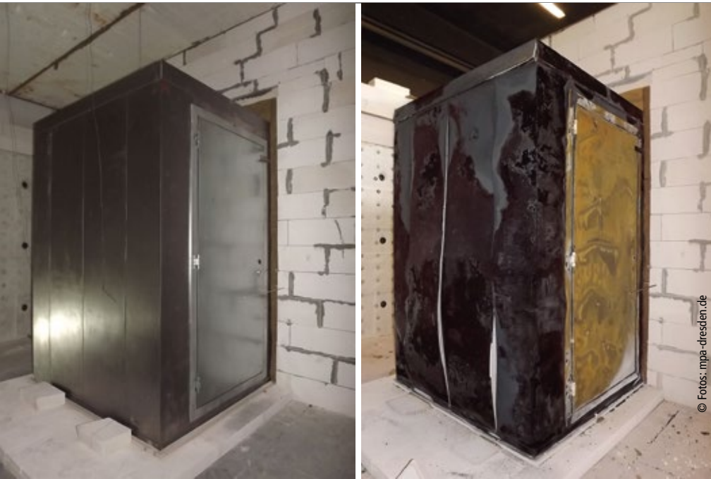
▲ Raum nach EN 1047-2 vor Brandtest (links) Raum nach EN 1047-2 nach Brandtest (rechts)
