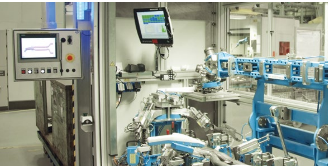
▲ Nur besonders ausgebildetes Personal darf an der Prüfanlage für den Abgasstrang sensible Einricht- und Wartungsarbeiten ausführen – dies stellt das elektronische Schlüsselssystem EKS sicher
