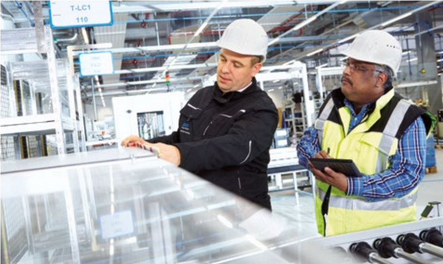
▲ Die Inspektion einer Maschine und Anlage ist nach der vorausgegangenen Maschinensicherheitsbewertung eine detaillierte Prüfung einer einzelnen Schutz-einrichtung, die sich aus den Forderungen der Betriebssicherheitsverordnung ableitet
