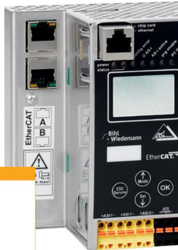
▲ AS-i 3.0 Ethercat Gateways, Safety over Ethercat (FSoE), mit Safe Link (BWU3418)
