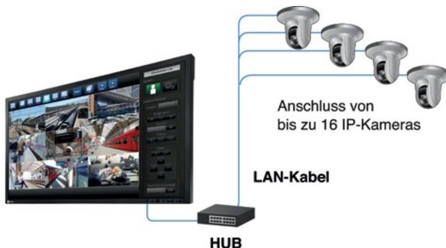
Eizo IP-Decoder-Monitor FDF4627W-IP für den computerlosen Anschluss an bis zu 16 IP-Kameras. Er beherrscht Steuerprotokolle für Axis- (VAPIX) und Panasonic-IP-Kameras sowie den ONVIF-Standard.
