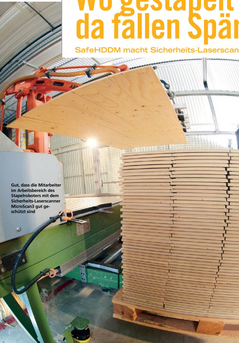
Gut, dass die Mitarbeiter im Arbeitsbereich des Stapelroboters mit dem Sicherheits-Laserscanner MicroScan3 gut geschützt sind
