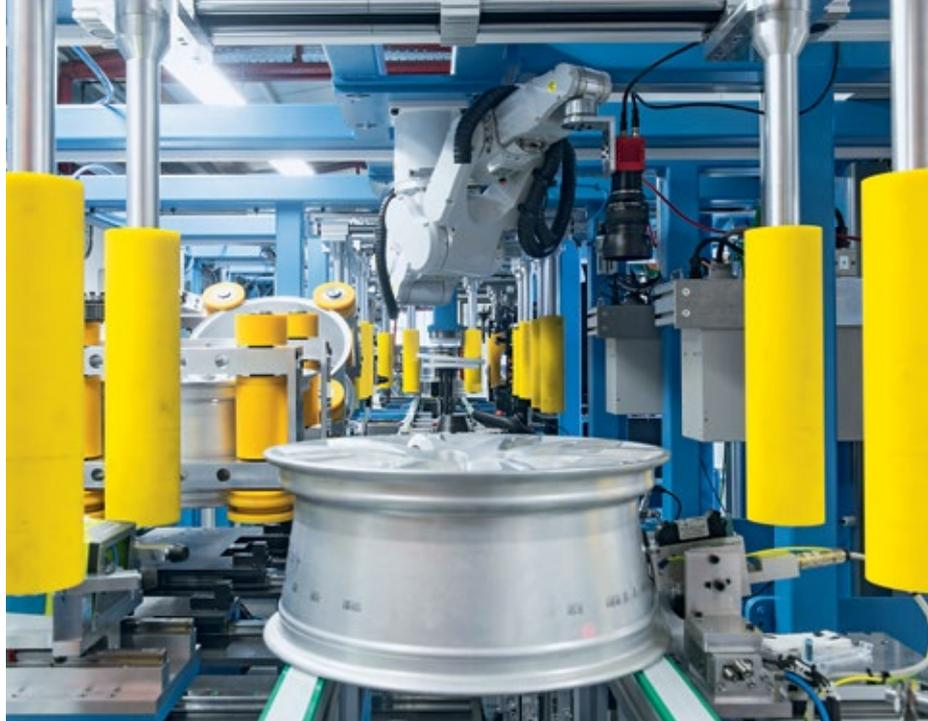
Die in der Anlage verbauten 39 Servoverstärker PMC protego D und PMC tendo DD5 mit Profinet-Anbindung von Pilz steuern die rotatorische als auch lineare Motorik
