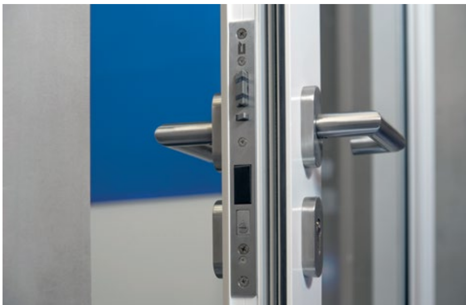
Automatische induktive Energieübertragung zwischen Schloss und Schließblech: Batterietausch und Verkabelung des Türblatts nicht mehr nötig (hier: Rohrrahmentür und induktive Lösung)
