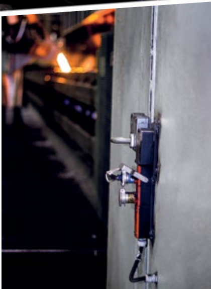
Die robuste Türzuhaltung von Fortress Interlocks bringt bis zu 10.000N Zuhaltkraft auf
