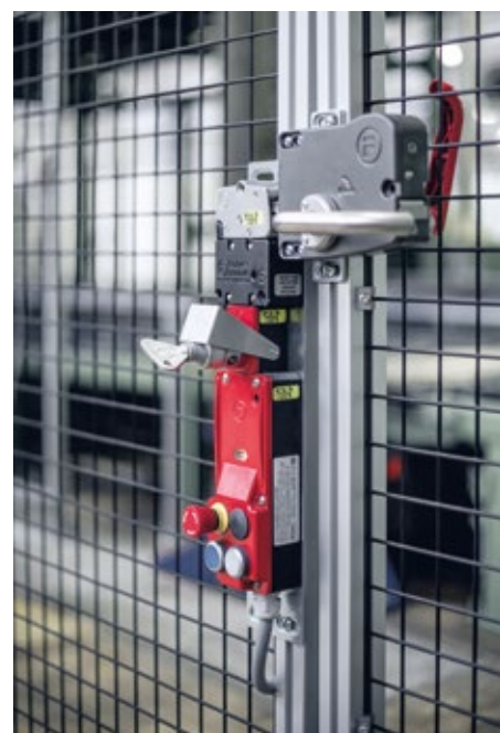
Sicherheitstürzuhaltung mit „Extracted Key“ zur Sicherheit
