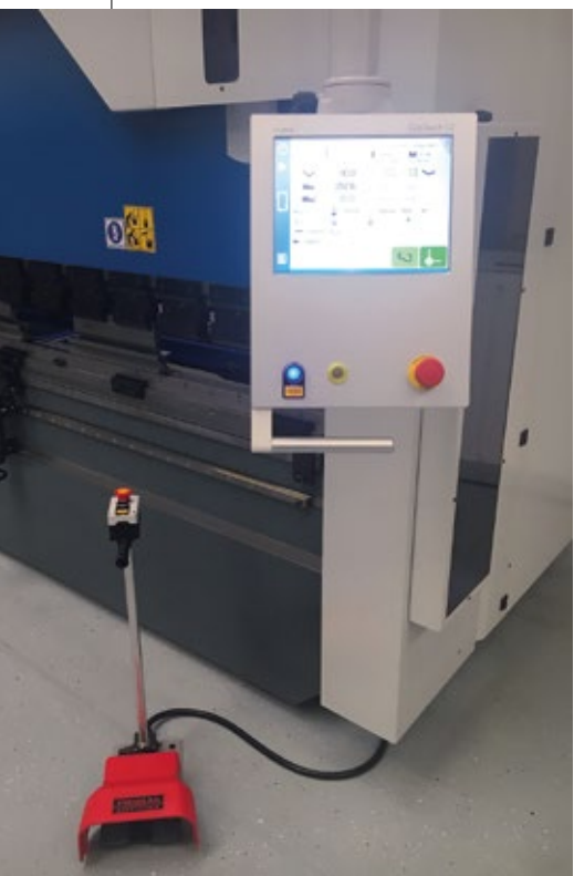
Die Gesenkbiegepresse kam aus einem nicht in der EU ansässigen Unternehmen und entsprach nicht der DIN EN12622
