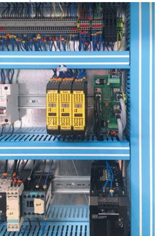
Stürmer Maschinen entschied sich für eine sicherheitstechnische Nachrüstung der Maschinen mit der neuen modularen Sicherheitssteuerung FMSC
