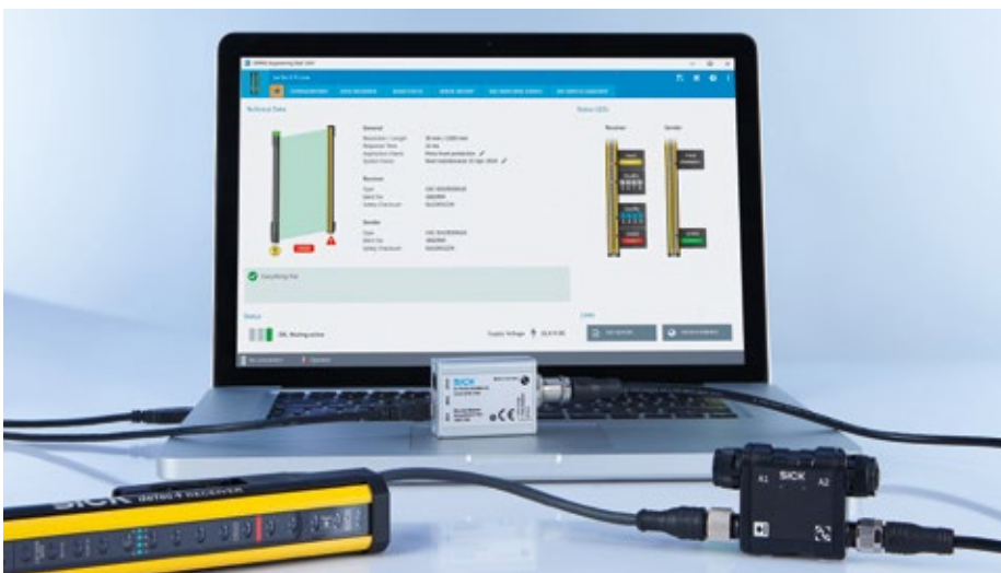
Die Sensorkommunikation per IO-Link sorgt für kontinuierliche Remote-Diagnosedaten sowie eine umfassende Datenanalyse und Visualisierung im SOPAS Engineering Tool (ET)
