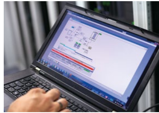
In gebündelter Form ermittelte Daten für den Administrator: Hauptaufgabe einer DCIM-Software ist die Echtzeit-Überwachung der physischen Infrastruktur eines Rechenzentrums mittels Sensorik
