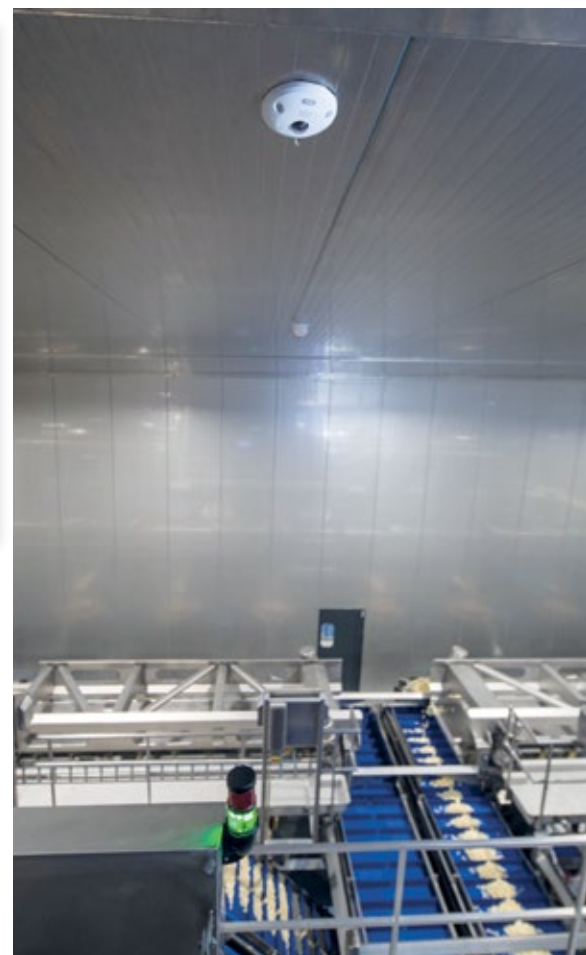
▲ Mit den Hemispheric IP-Domekameras können Störungen im Produktionsprozess schnell entdeckt werden
