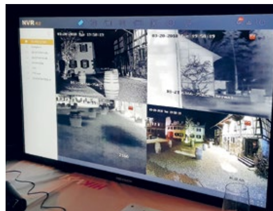
DeepinMind NVR Live-Demonstration. Links oben: PTZ DeepinView Kamera; rechts oben und links unten: Thermal-Bild; rechts unten: DarkFighter-Funktion
