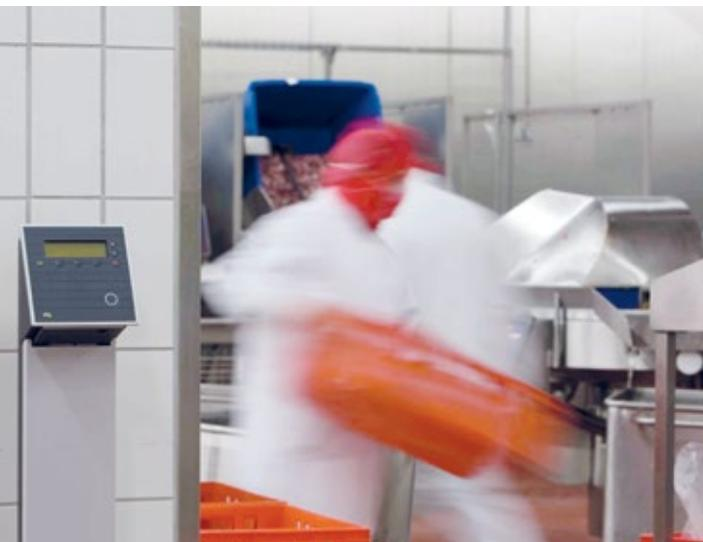
Die Zutrittsleser müssen IP65-wasserdicht sein, die Gehäuse komplett geschlossen und unter Umständen mit Heizung ausgestattet sein
