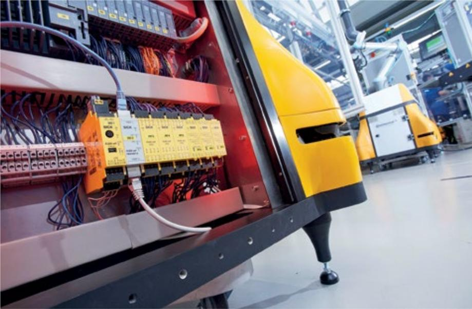
Alles, was zum Thema Sicherheit in dem System steckt, wird über die Software-programmierbare Sicherheitssteuerung Flexi Soft gesteuert
