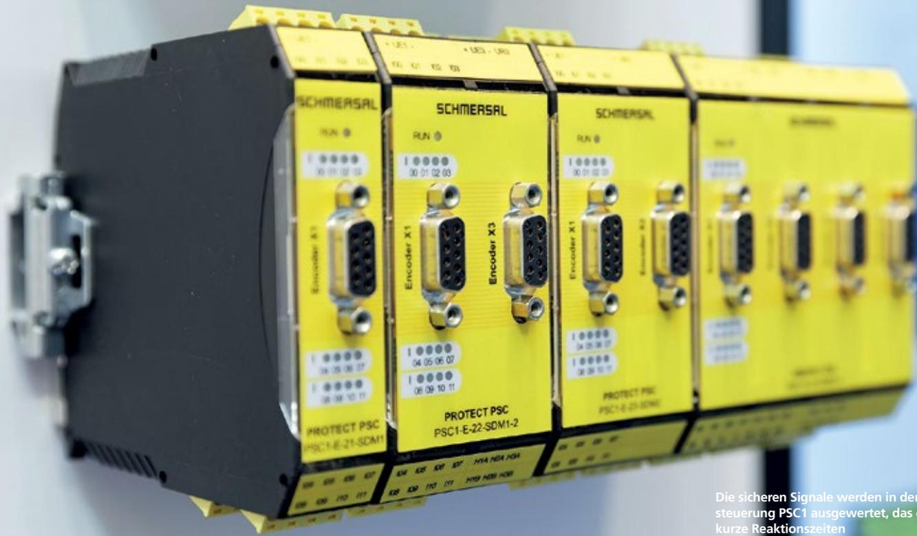
Die sicheren Signale werden in der Sicherheitssteuerung PSC1 ausgewertet, das gewährleistet kurze Reaktionszeiten
