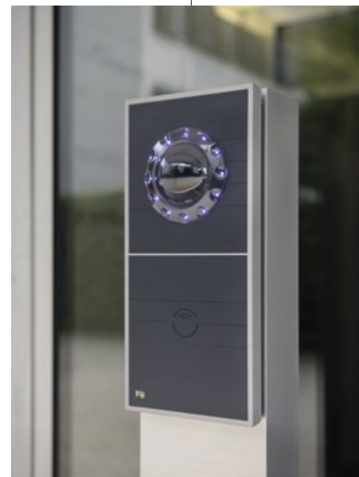
Handvenenerkennung basiert auf der Absorption von Infrarotstrahlen (Wärmestrahlen) in venösem Blut
