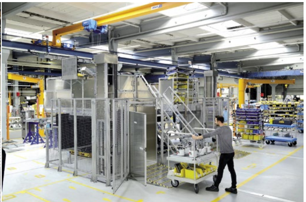
▲ Das für die Montage der Kärcher-Portalwaschanlage benötigte Material und Werkzeug wird in extra hierfür entwickelten Transportwagen in den Materialaufzügen der Hymer-Arbeitsbühne sicher und ergonomisch auf die gewünschte Arbeitshöhe gebracht
