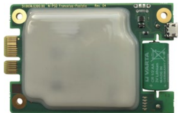
Abb. 2: HSM mit vergossener cryptographic boundary
